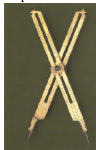
Figura 15: un compasso di proporzione in ottone dorato (xvi sec)
