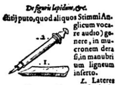
Figura 2. L'evoluzione di un sistema: il portagrafite cinquecentesco descritto da Gessner ed un portamatite regolabile dell'800
