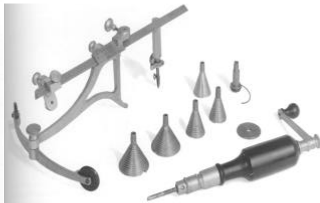
Figura 20: Volutor , strumento per tracciare spirali (Londra, 1857)
