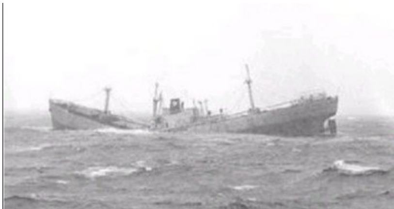
Nel novembre 1943 la S.S. John P. Gaines, una delle Liberty di prima generazione, si spezzò in due tronconi al largo delle isole Aleutine durante una tempesta, prima di affondare rapidamente. Gli esperti imputarono il cedimento strutturale alle saldature e al tipo di acciaio impiegato.
